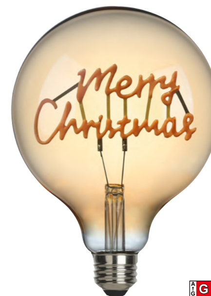
Leuchtmittel, Glas: Amber Bulb, glass: amber 1,5 Watt · LED · 2000K · 70lm · E27 Ra 90 · 15.000h · h: 17,5 cm · Ø 12,5 cm 625149 | LM FILAMENT "MERRY CHRISTMAS"
