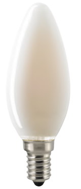
Leuchtmittel, Glas: weiß matt, dimmbar Bulb, glass: white matt, dimmable 4,5 Watt, LED, 2700K, 470lm, E14 Ra >90 · 15.000h · h 9,7 cm x Ø 3,5 cm 6132901 | LM FILAMENT "KERZE"
