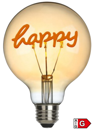
Leuchtmittel, Glas: Amber Bulb, glass: amber 1,5 Watt • LED • 2000K • 60lm • E27 Ra 90 • 15.000h • h: 14 cm • Ø 9,5 cm 625104 | LM FILAMENT "HAPPY"
