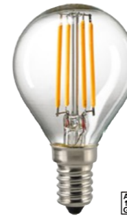
Leuchtmittel, Glas: klar, dimmbar Bulb, glass: clear, dimmable 4,5 Watt, LED, 2700K, 470lm, E14 Ra >90 · 15.000h · h 8 cm x Ø 4,5 cm 6134401 | LM FILAMENT "KUGEL"
